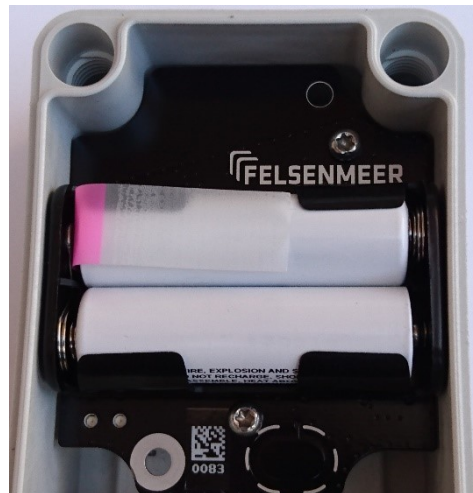
Abbildung 2: Offen, mit Isolationsband
